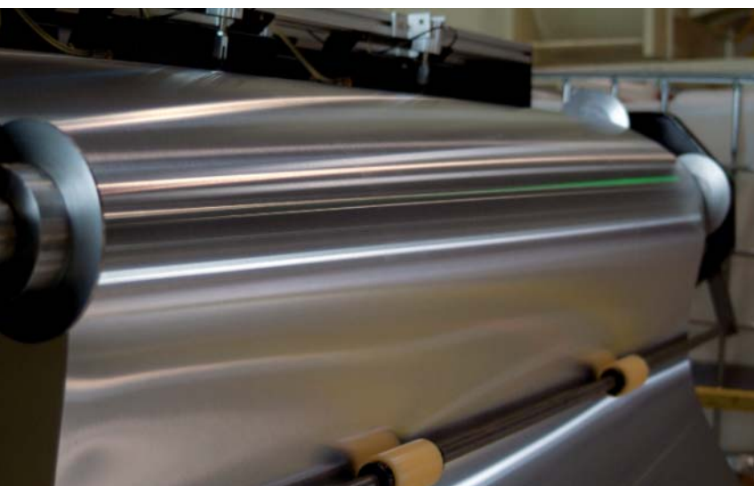
Sa aluminijumskim koturom težine oko 10 tona počinje proces proizvodnje limenki u našoj fabrici.
